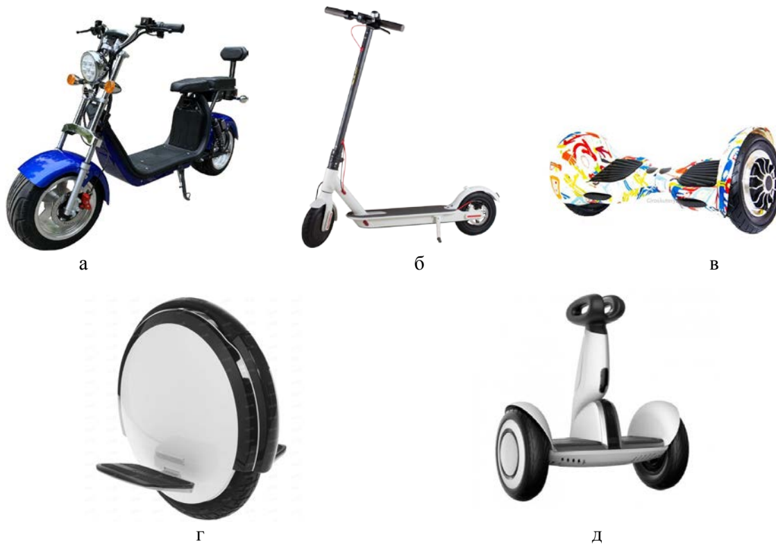
Рисунок 1 – Персональні електро-транспортні засоби: а – електроскутер; б – електросамокат; в – гіроскутер (гіроборд); г – моноколесо; д – сегвей
