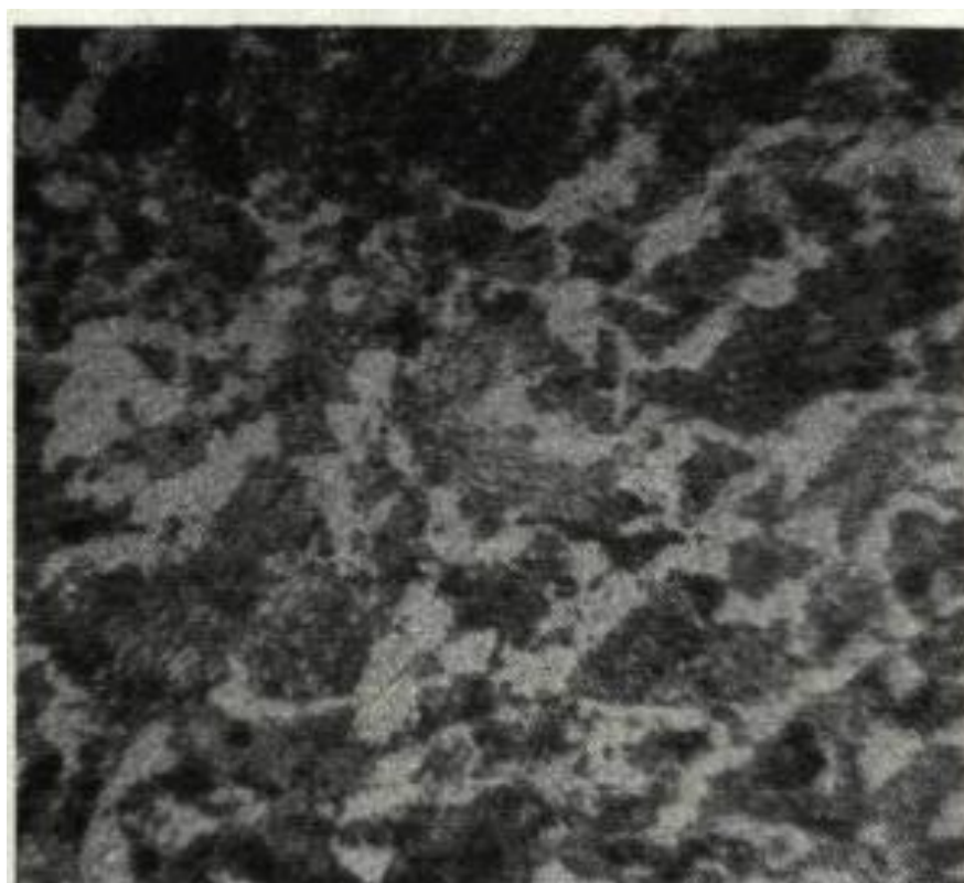
Рис.3.10. Мікроструктура на поверхні деталі сталі 45 в зоні максимального зносу: а) \times 100 ; б) \times 500
