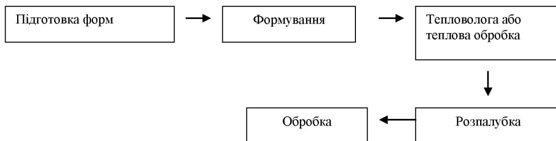
Рисунок 3 - Стадії технологічного процесу виготовлення залізобетонних виробів
