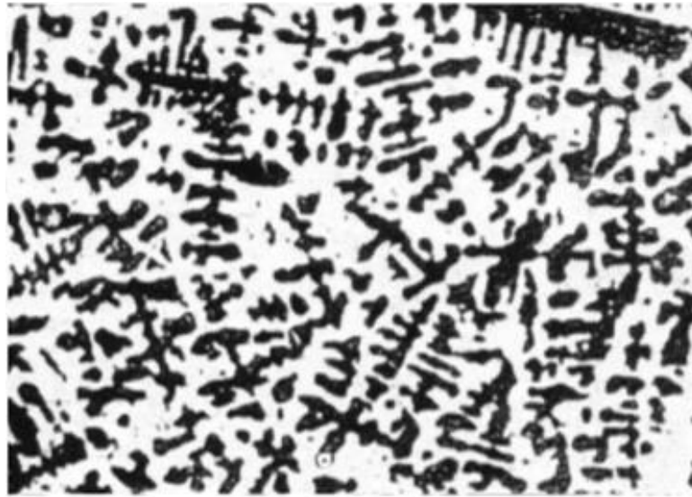
Рисунок 7.1 - Мікроструктура литої олов'яної бронзи із 5% Sn, x 100. Видно темні осі дендритних зерен бідного оловом твердого розчину. Проміжки між осями - твердий розчин, збагачений оловом
