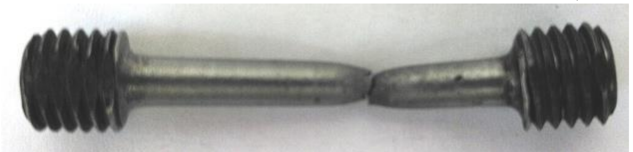
Рис. 3.1 - Зовнішній вигляд зразків для випробувань на розтяг при визначенні міцності і пластичності металевих матеріалів: а – до випробування; б – після випробування
