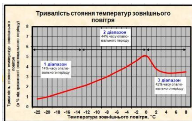
Рис. 5.3. Графік тривалості стояння температур зовнішнього повітря
