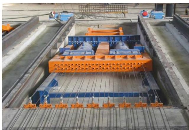
Рисунок 1.10. - Гідравлічні упори для багаторядного натягу арматури
