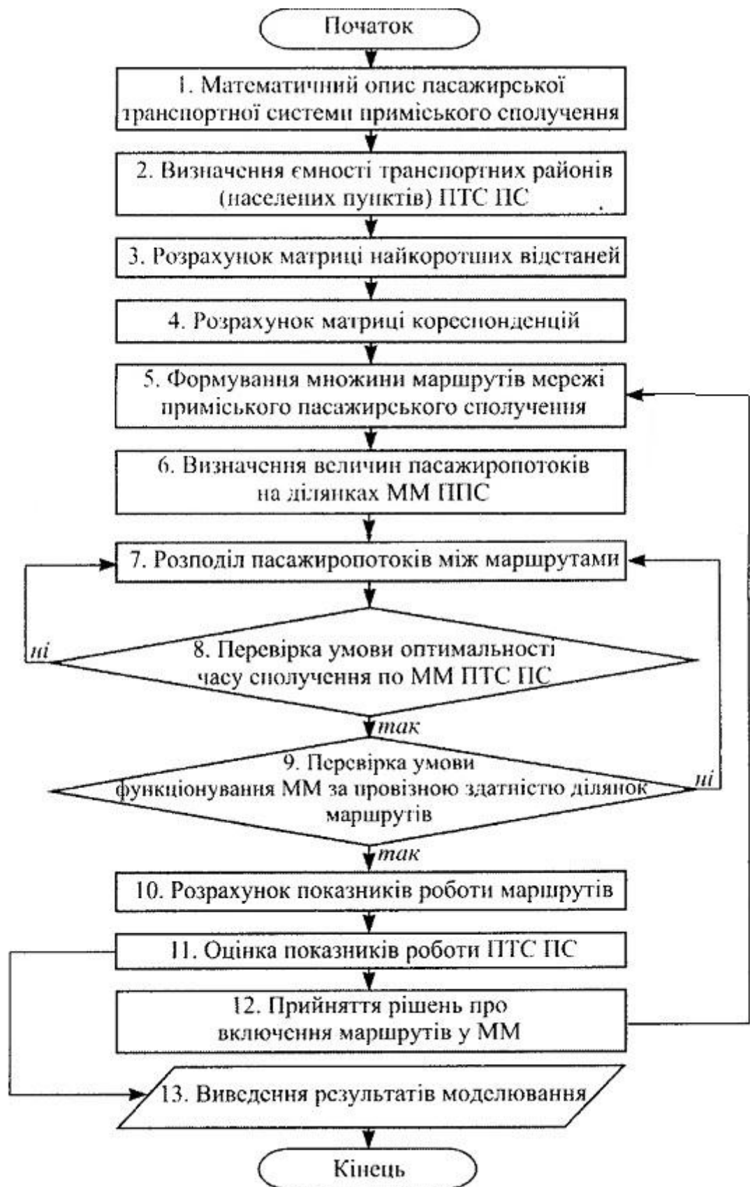
Рисунок 2.1 - Схема алгоритму математичного моделювання процесу пасажирських перевезень на маршруті
