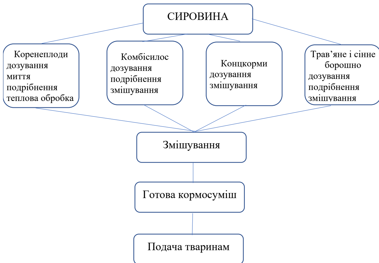
Рис. 3.1. Технологічна схема приготування кормів
