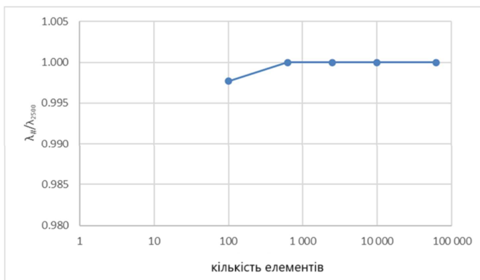
Малюнок 2.5. Дослідження розміру сітки пластини на основі аналізу вигину.
