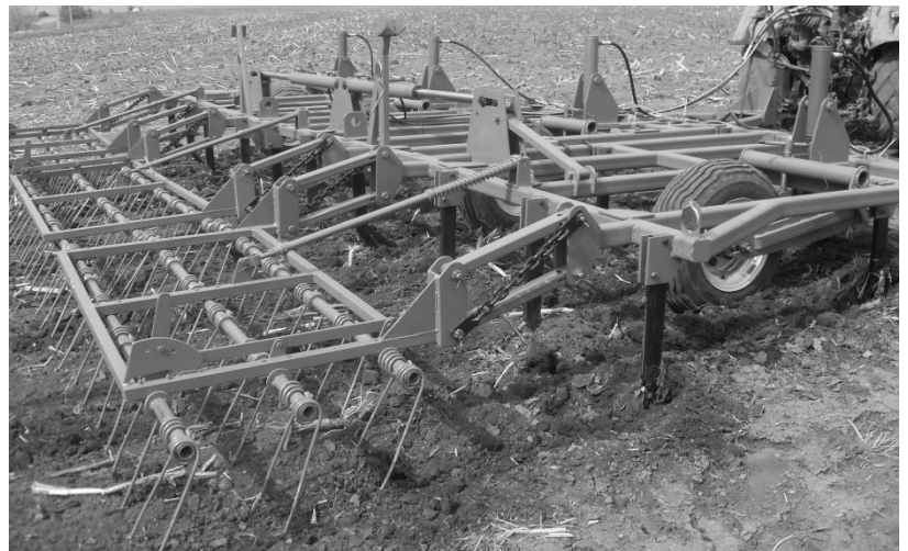
Рис.3.1. Загальний вигляд комбінованого експериментального культиватора на базі якого поведені дослідження показників функціонування борін з пружинними зубами
