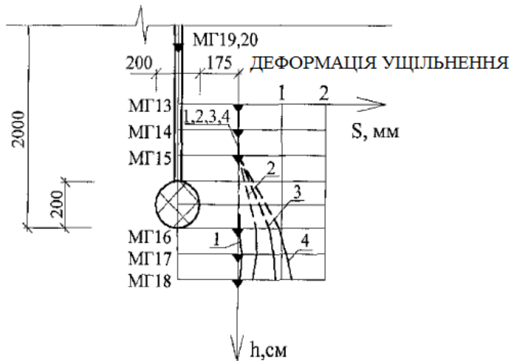
Рис. 3.24. Деформації ґрунтового масиву у вертикальних площинах при фіксованих рівнях навантаження нагнітаємого елемента діаметром 0,2 м;
