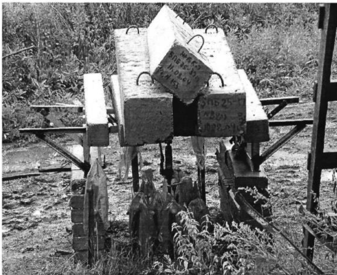
Рис. 3.4. Експериментальна установка для проведення статичних випробувань несучих елементів, що нагнітаються, і паль.
