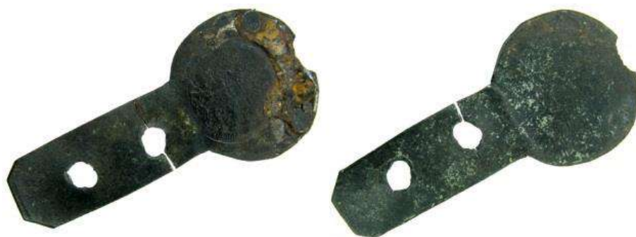
Рис. 69. Половина ливарної форми для підробки 20 копійок 3 .
