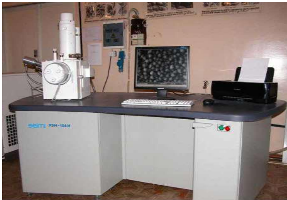
Рисунок 42 - Зовнішній вигляд сканувального електронного мікроскопа РЕМ-106И
