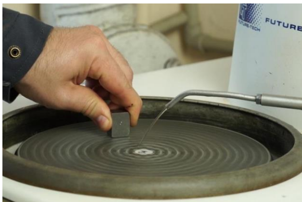
Рисунок 28. Шліфування темплета на шліфувально-полірувальній машині
