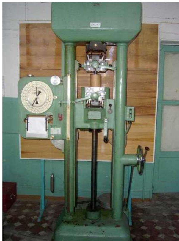
Рис. 45. Випробувальна розривна машина ZDM-10
