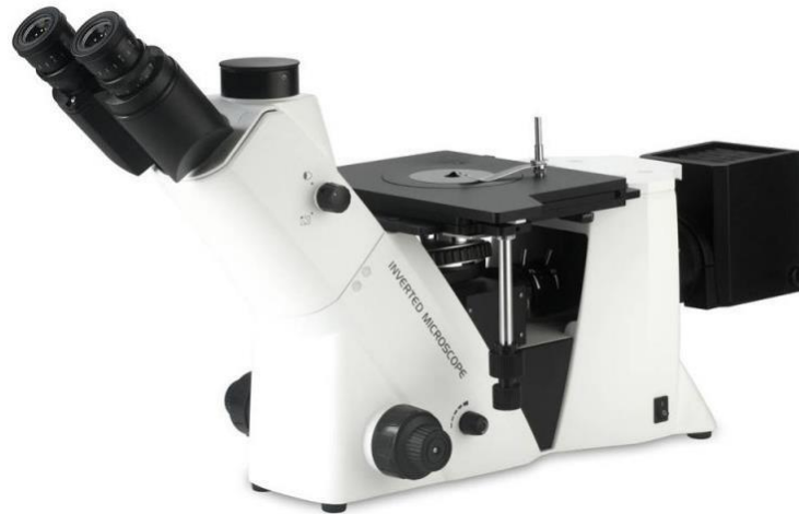
Рисунок 32 - Металографічний мікроскоп моделі ММВ
