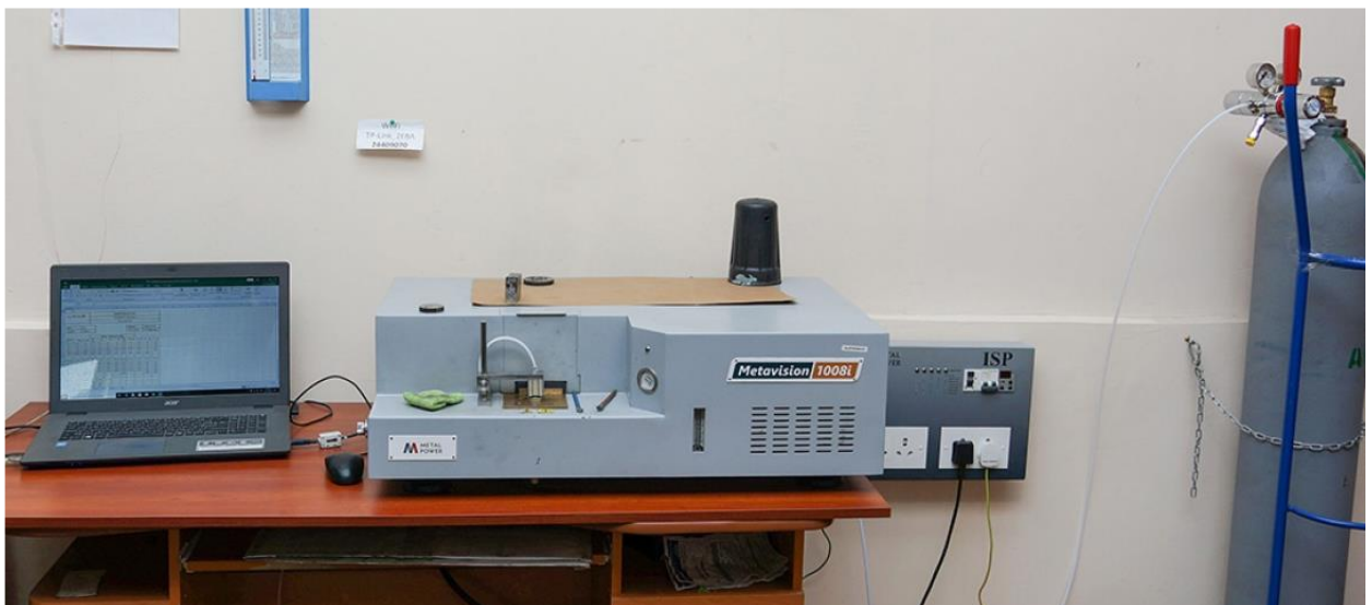
Рисунок 12. Оптико - емісійний аналізатор Metavision 1008i виробництва компанії MetalPower
