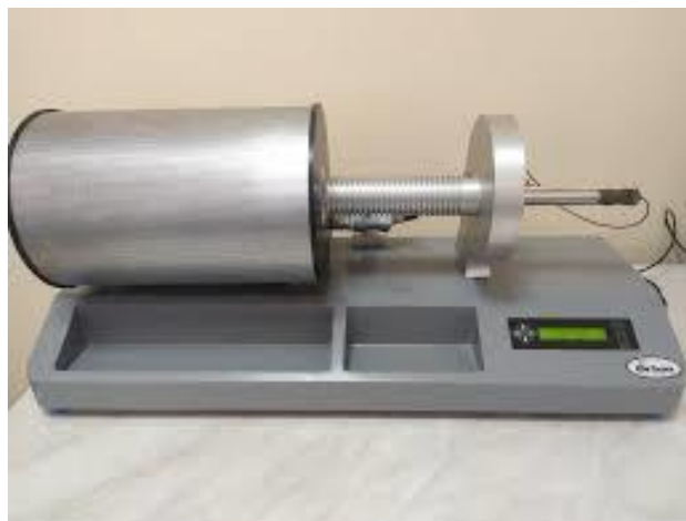
Рисунок 26 - Дилатометр з горизонтальним штовхачем
