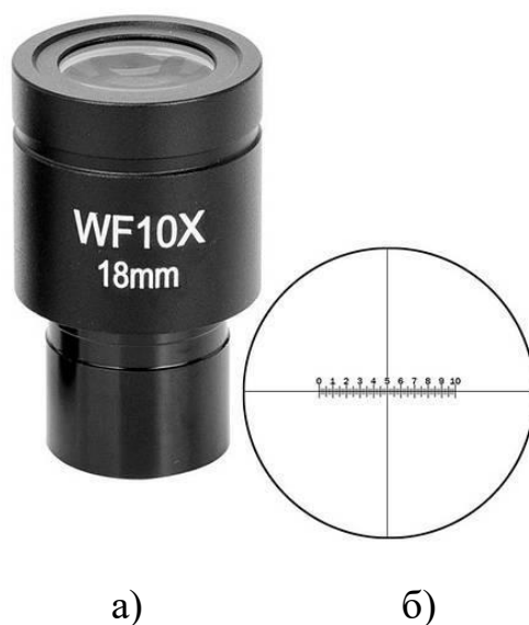
Рисунок 33 - Окуляр - мікрометр: зовнішній вигляд (а); вимірювальна шкала (б)
