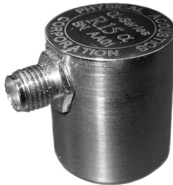
Рисунок 54 - П'єзоелектричний датчик акустичної емісії
