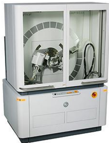
Рисунок 20 - Рентгенівський дифрактометр призначений для рентгено-структурних досліджень кристалічних матеріалів
