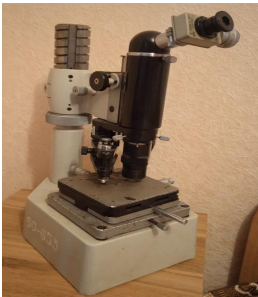
Рисунок 51 - Прилад для вимірювання мікротвердості моделі ПМТ-3
