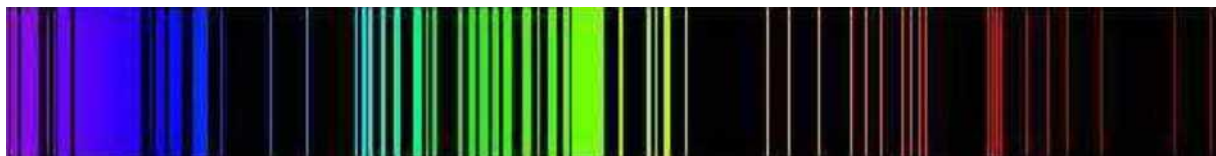
Рисунок 10 – Лінійчатий спектр випромінювання заліза
