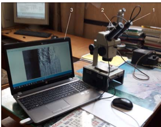
Рис. 2.5. Комплекс для дослідження глибини i впровадження пуансона в матеріал до виникнення тріщин, що сколюють: 1 – цифрова камера Sigeta MDC-200 2,0 MP для мікроскопу; 2 – мікроскоп; 3 - ноутбук з програмою обробки фотографічних знімків TourView 3,7
