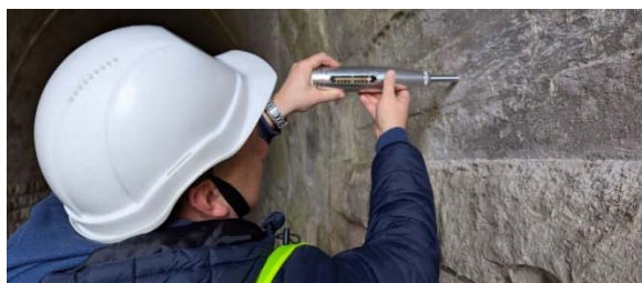
Рисунок 9 — Визначення поверхневої міцності бетону на тиск, місце випробування — Ланка 2
