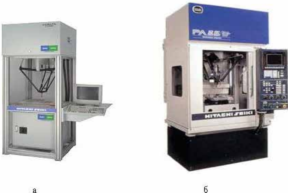
Рис. 1.13. Технологічне обладнання з паралельною кінематикою типу «Дельта» для складальних робіт (а) та свердління (б) фірми HITACHI SEIKI (Японія)
