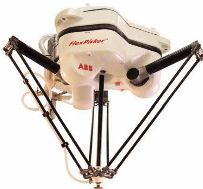
Рис. 1.14. Робот типу «Дельта» мод. IRB 340 FLEXPICKER фірми ABB FLEXIBLE AUTOMATION (Швеція)
