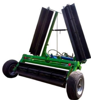
Загальний вигляд макетного зразка котка-подрібнювача на базі якого проводили польові експериментальні дослідження
