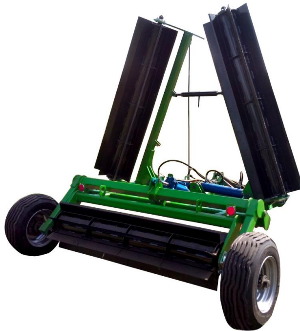
Рис. 3.2. Загальний вигляд серійного подрібнювача рослинних решток соняшнику який використовували при проведенні польових експериментальних досліджень.
