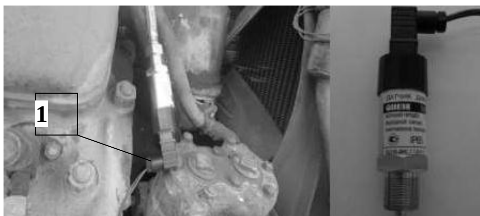
Рисунок 3.6 - Датчик тиску повітря та його встановлення на двигун СМД-62.
