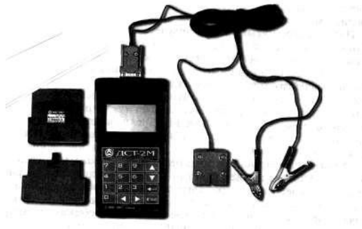
Рисунок 2.14 – Сканер ДСТ-2М зі змінними картриджами та адаптером.
