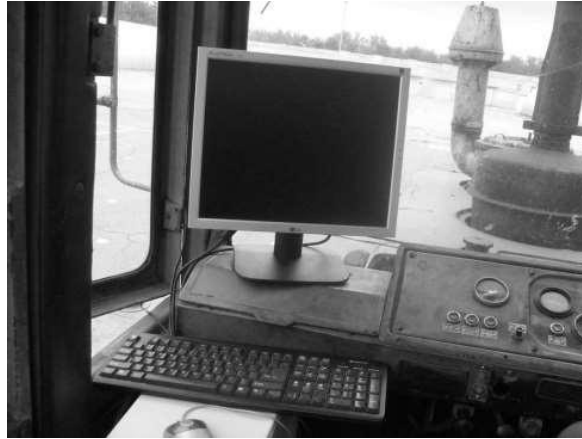
Рисунок 3.11 - Комплекс підготовлений для запису показників тиску наддуву.
