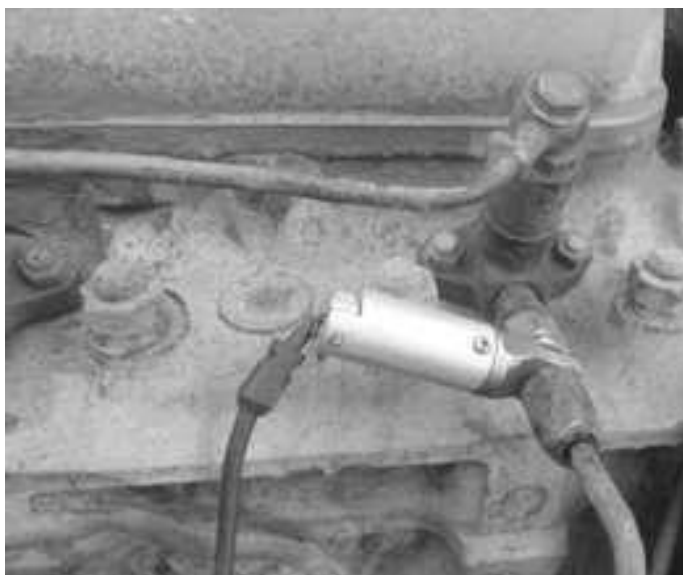
Рисунок 3.5 - Встановлення датчика палива тиску в паливопроводі.
