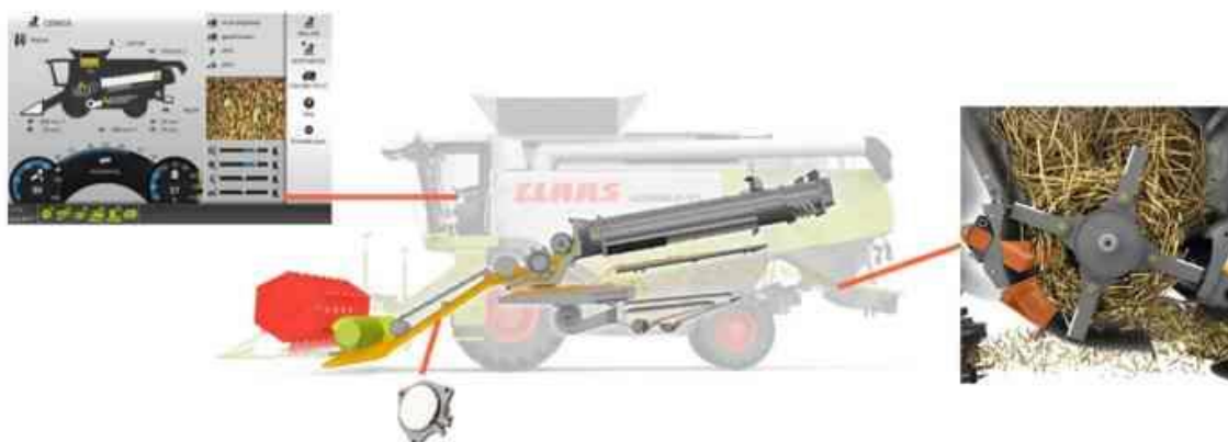
Рис. 3.5. Система подрібнення соломи CEMOS AUTO CHOPPING
