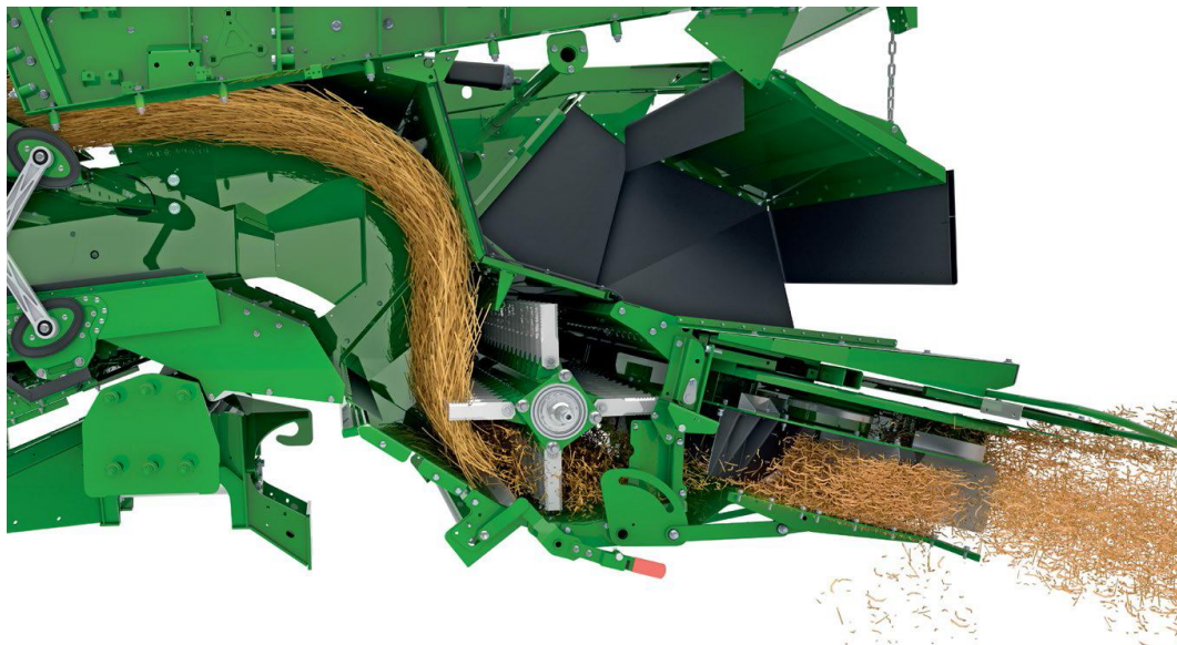
Рис. 3.8. Схема роботи комбайна при подрібненні соломи
