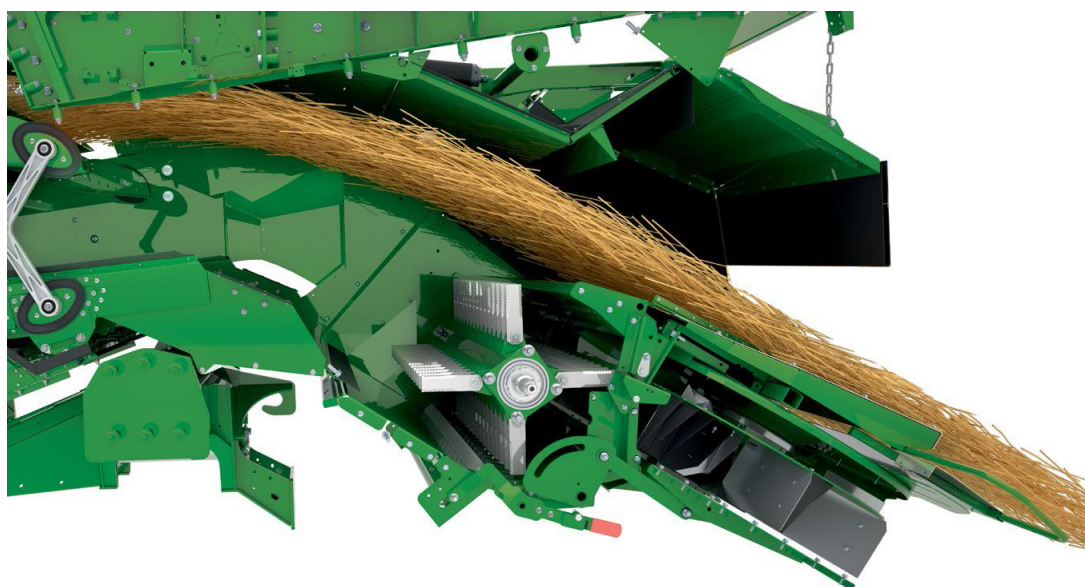
Рис. 3.9. Схема роботи комбайна при скиданні соломи у валок
