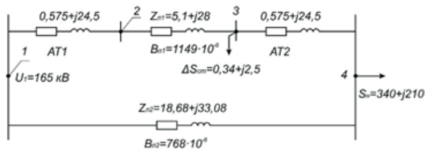
Рис.4.6. Схема заміщення для замкненої мережі
