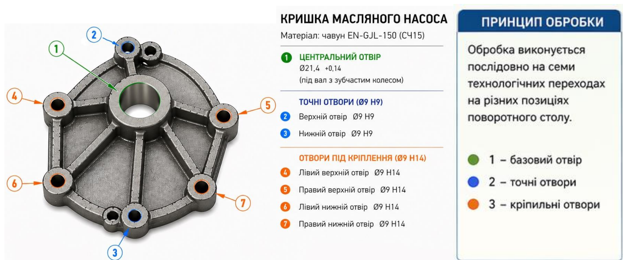
Рисунок 1 – Схема розташування оброблюваних отворів на деталі
