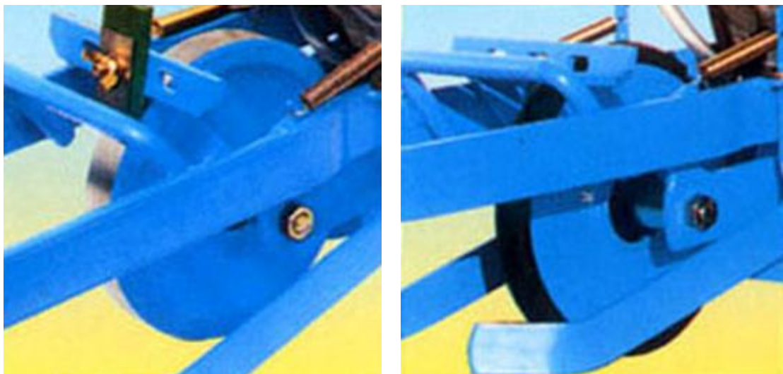
Рис. 3.5 Вузькі циліндричні котки металеві та з гумовими шинами
