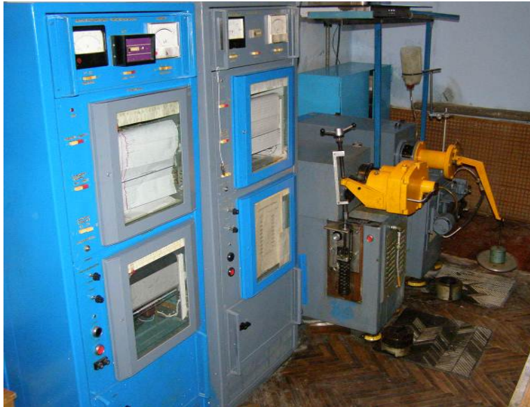
Рисунок 2 – Загальний вид машини тертя 2070 CMT-1
