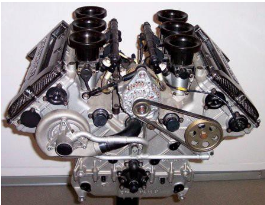
Рис.11. Двигун без механізму зміни фаз газорозподілення.
