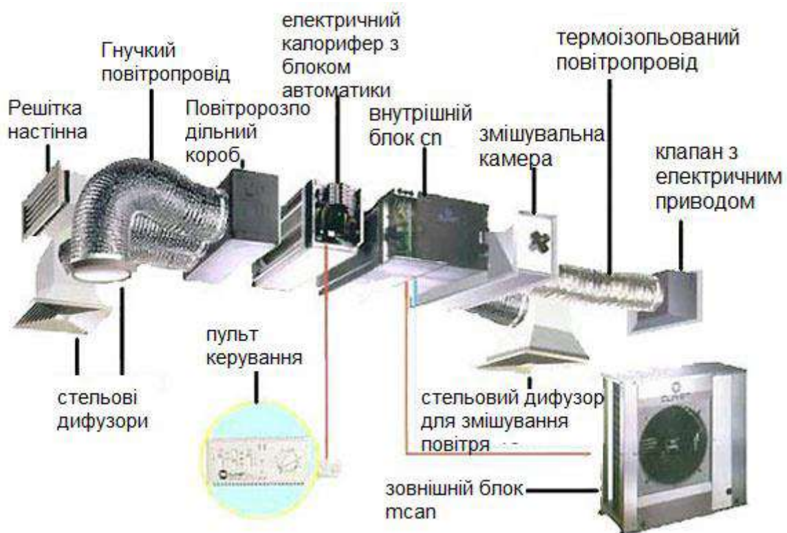
Рис. 1.5. Конструктивне виконання спліт-системи
