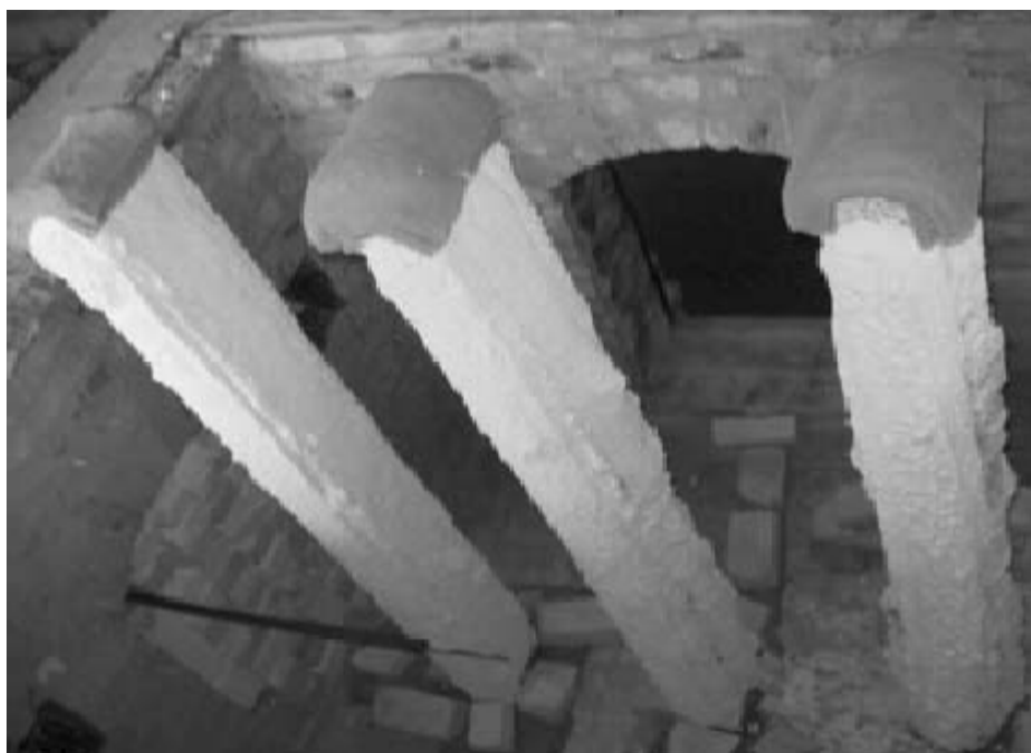
Рис. 2.7. Вид сталевих колон з вогнезахисним покриттям яке спучується, в печі після проведення випробувань.
