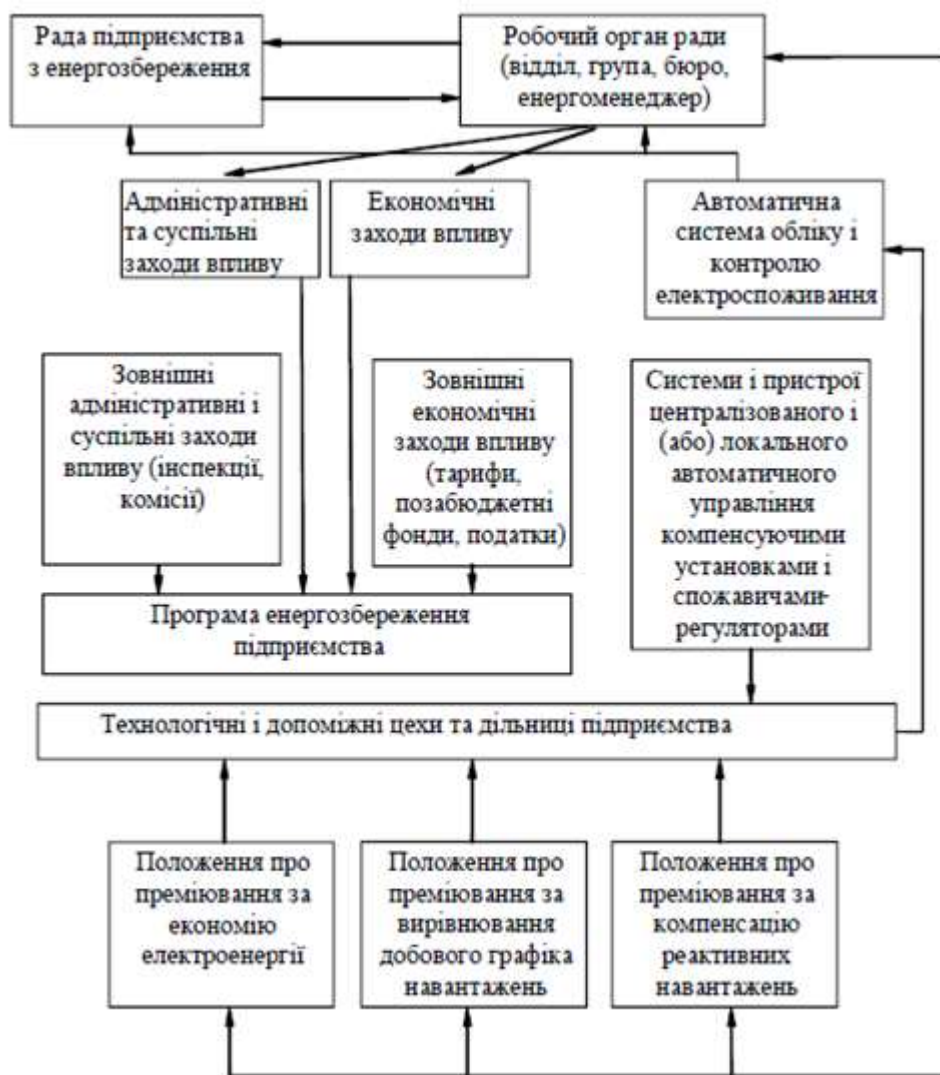
Рис. 2.3. Схема організаційних заходів із зменшення витрат електроенергії на промислових підприємствах
