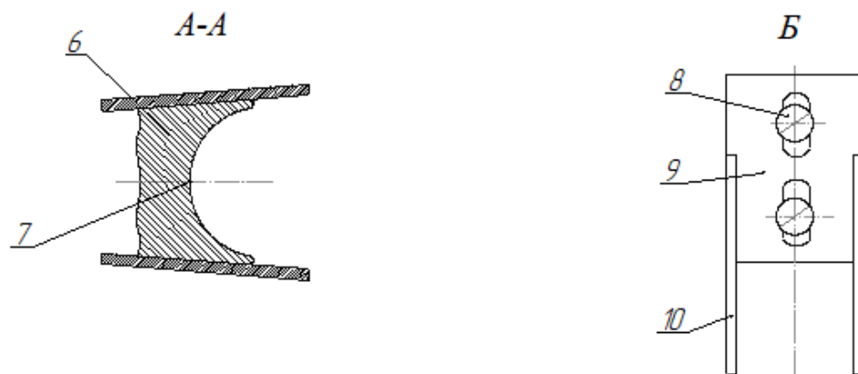
1- корпус; 2 - вісь; 3 - ступиця; 4 - диск; 5 - лійка; 6 - п'ята; 7 - конструкція відбивача; 8 - гвинт; 9 - пластина; 10 - загортач; 11 - п'ятка загортача.
