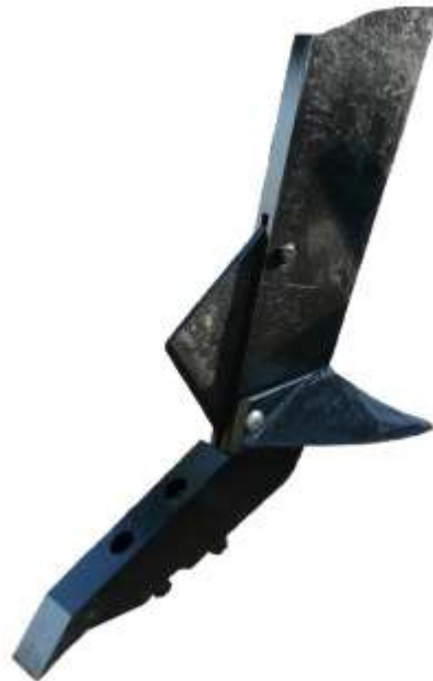
Рис. 5. Загальний вигляд чизельної лапи із крилами обтічної форми у вигляді хвоста дельфіна
