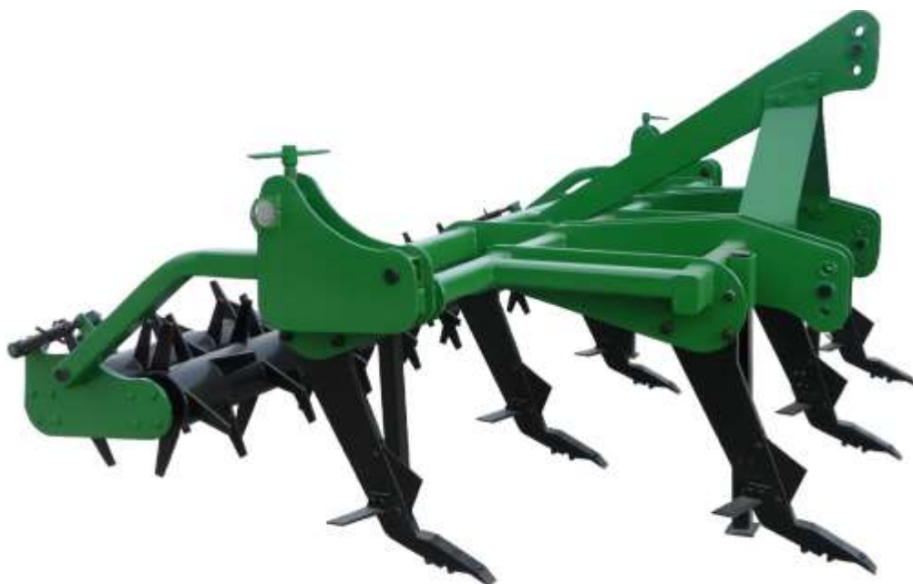
Рис. 4. Загальний вигляд комбінованого чизельного ґрунтообробного агрегату ЧН-3,5
