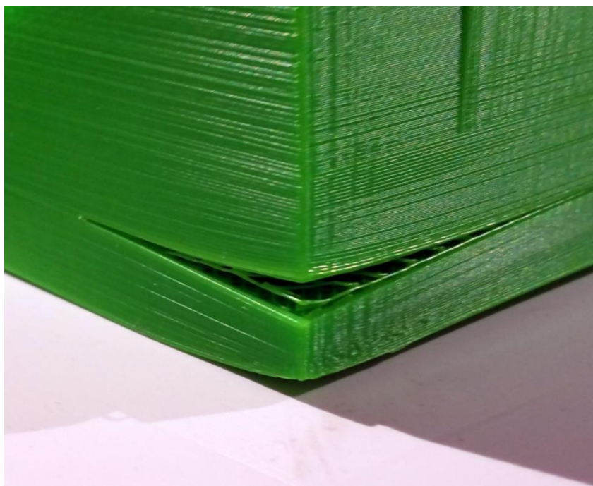
Рисунок 1.2 – Дефекти відшарування в процесі 3D-друку деталей внаслідок нерівномірності розподілу температури
