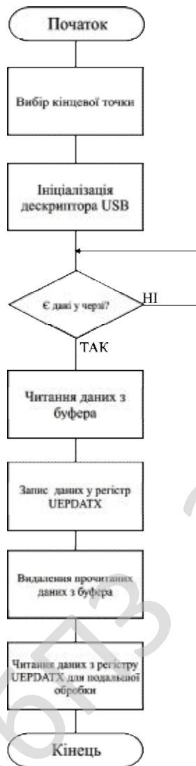
Рисунок 4.3 – Блок-схема роботи підпрограми зчитування даних з FIFO-буферів кінцевих точок
