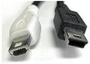
Рисунок 1.7 – Mini USB Тип А (ліворуч) і Mini USB Тип В (праворуч)
