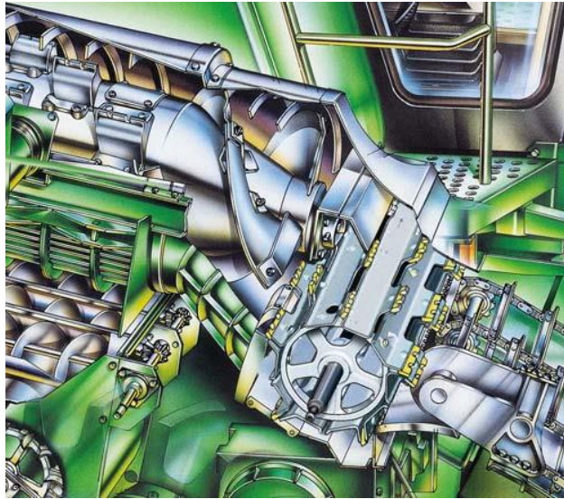
Рис. 4.2. Система обмолоту STS комбайна John Deere 9750 STS
