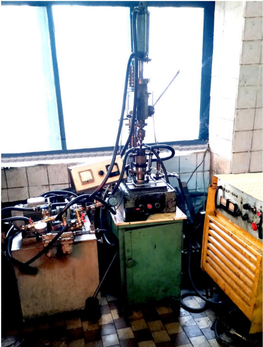
Рис.2.2. Установка РОД з використанням ЕЕГ встановленої на настільному свердлувальному верстаті
