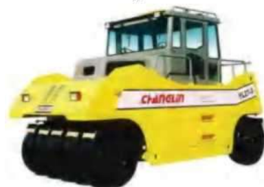
Рисунок 1.3 – Котки статичної дії: а - одновальцевий; б - на пневматичних шинах.
