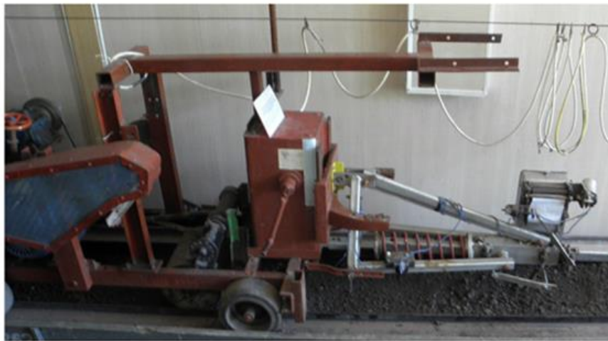
Рис. 3.11. Загальний вигляд лабораторної установки для дослідження параметрів функціонування лапи з пружною ланкою
