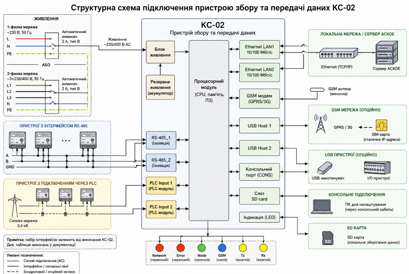
Рисунок 8.7 – Типова структурна схема АСКОЕ на базі НІК-КЦ-02
