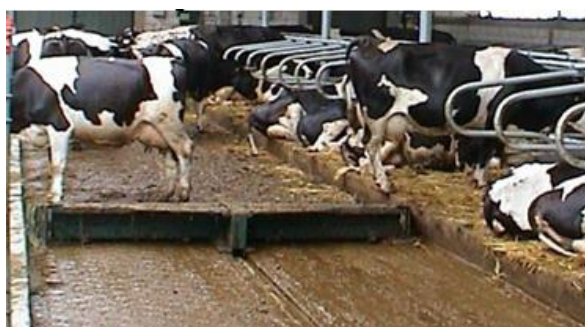
Рис. 2.5 – Механічна (скреперна) (а) та гідравлічна (б) системи видалення гною
