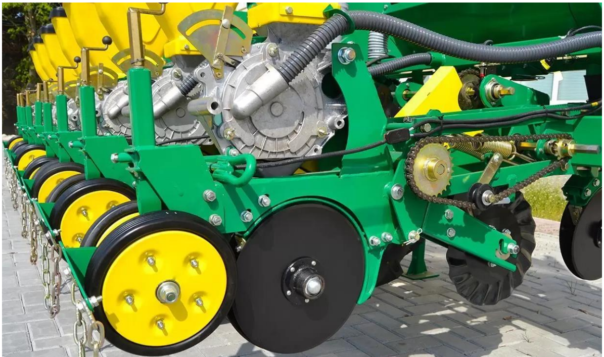
Рис. 2.13. Посівна секція сівалки MULTICORN 560 PRO (03)
