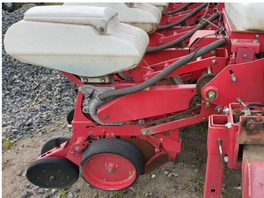
Рис. 2.3. Посівна секція сівалки VEGA 8 PROFi
