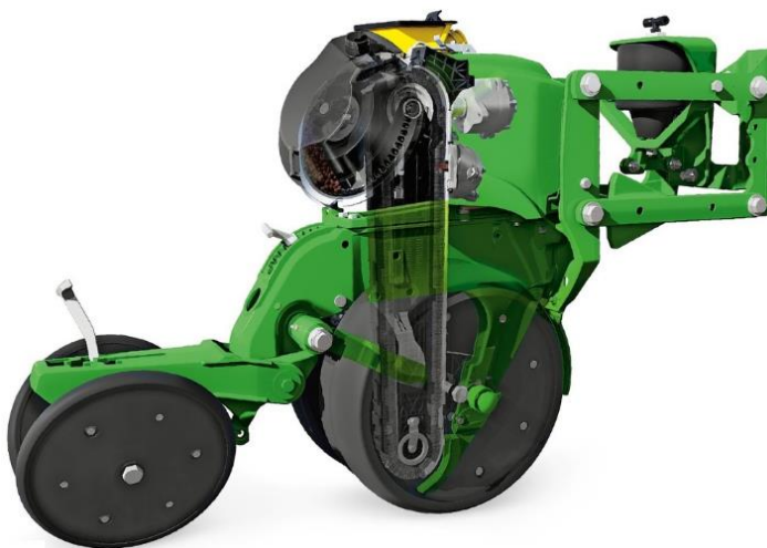
Рис. 2.23. Посівна секція EXASTEMERGE
