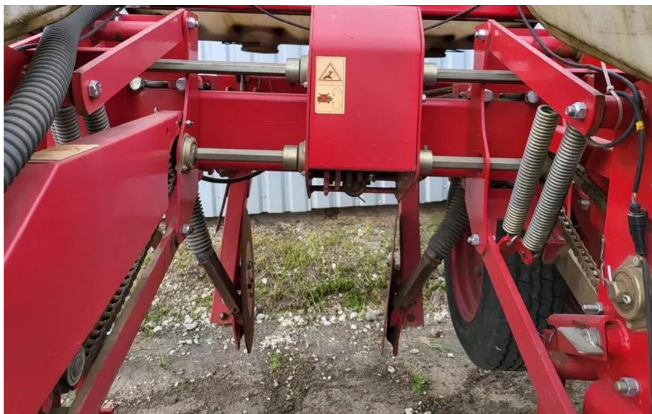
Рис. 2.4. Посівні секції та механізм передач сівалки VEGA 8 PROFi
