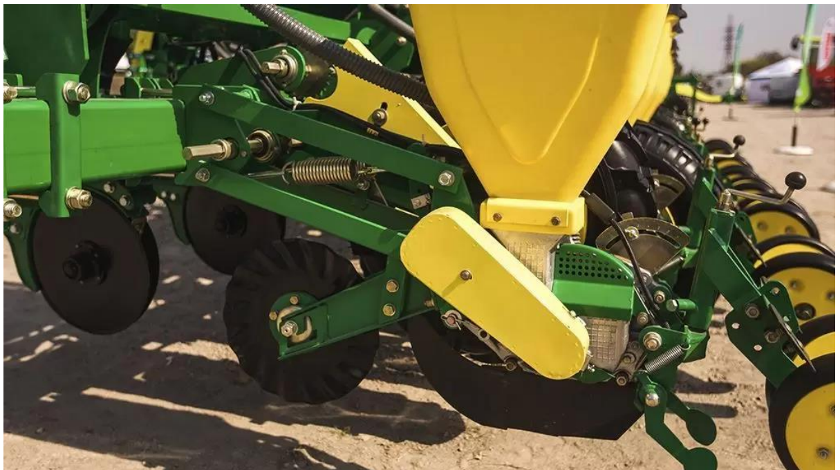
Рис. 2.11. Посівна секція сівалки MULTICORN 560 (01)
