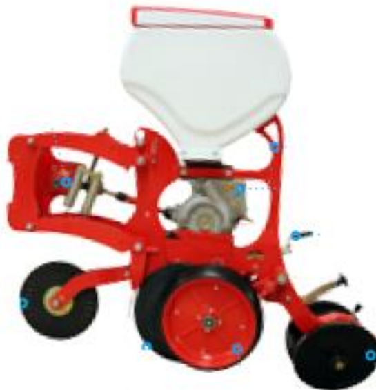
Рис. 2.18. Посівна секція сівалки PLANTER–D8
