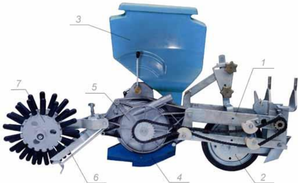
Рис. 2.9. Посівна секція сівалки СТВТ–12
