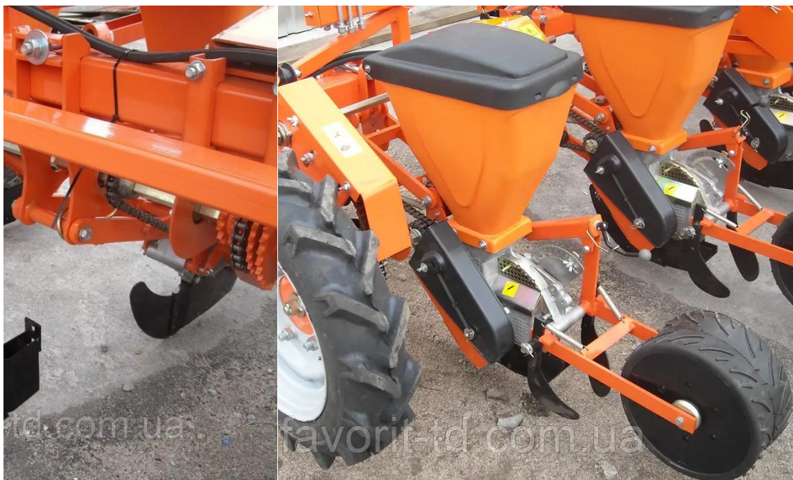
Рис. 2.5. Посівна секція сівалок Весна–4, Весна–6 та Весна–8
