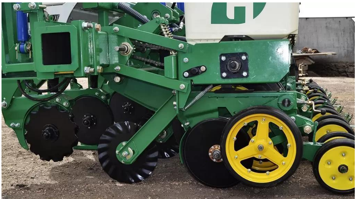
Рис. 2.14. Посівна секція сівалки MULTICORN560 (01)
