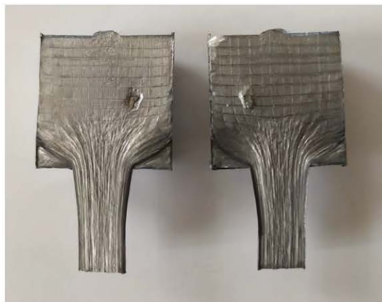
Рис. 25. Прес-залишок для сталюї стадії пресування свинцевих зразків через пряму симетричну одноканальну матрицю із гладкого контейнера ( \lambda = 9 )
