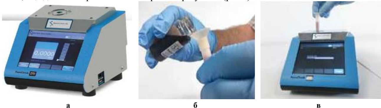
а – загальний вигляд, б, в – процес відбору зразків Рисунок 1 - Магнітометр FerroCheck 2100
