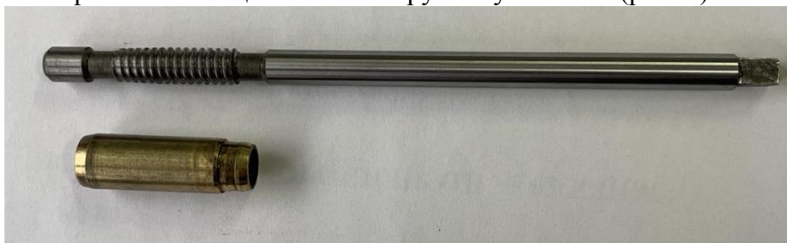
Рисунок 2 – Спеціальний інструмент для відновлення втулок клапанів.
