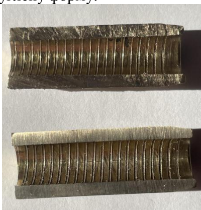
Рисунок 3 – Спіральні маслоутримувальні канавки прямої втулки клапана
