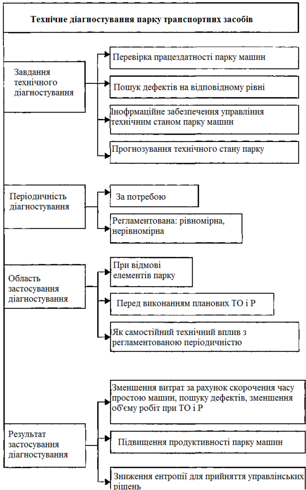
Рисунок 1 – Схема діагностування основних елементів парку транспортних засобів
