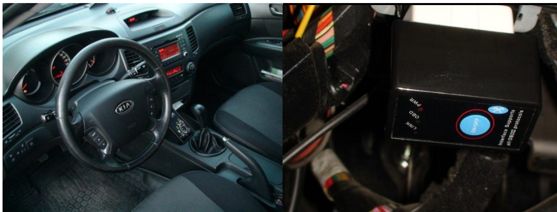
Рисунок 3 – Загальний вигляд елементів бортової системи моніторингу параметрів технічного стану (СМПТС) та положення ТЗ, обладнаного системою впорскування газового палива в умовах експлуатації засобами ITS: розташованого в автомобілі KIA Magentis 2.0 5МКПП та бортовий діагностичний сканер - адаптер Scanmaster ELM
