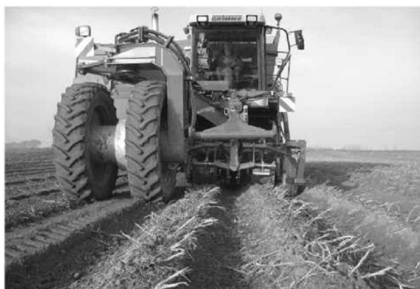
Картоплезбиральний комбайн SF150/170-60
