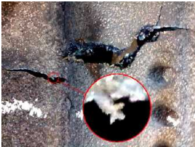
Рисунок 3.6 – Дефект гарячих тріщин у вигляді розриву тіла виливки та вигляд дендриту з гілками другого порядку
