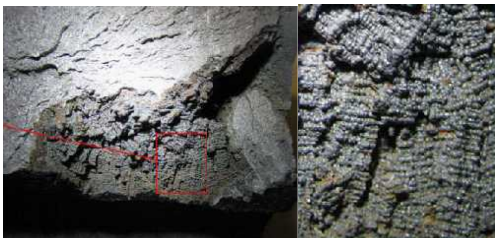
Рисунок 3.3 – Гаряча тріщина у вигляді надривів з нерівною окисленою поверхнею по межах кристалів
