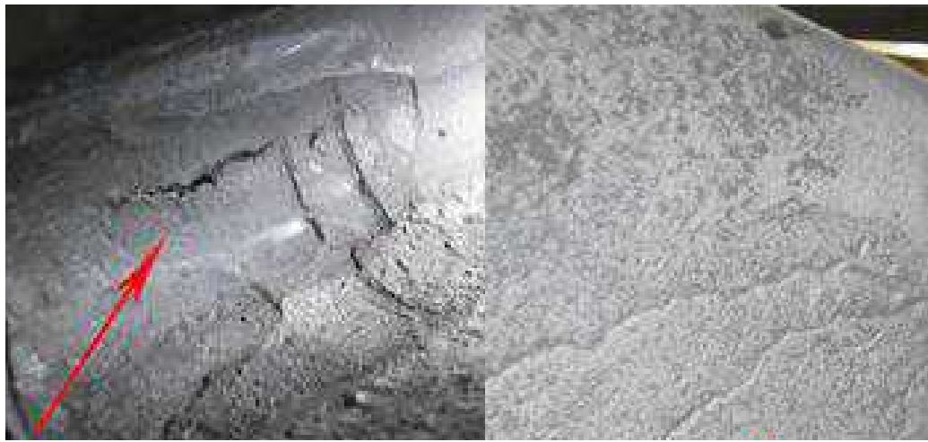
Рисунок 3.4 – Гаряча тріщина (а) та не злиття
