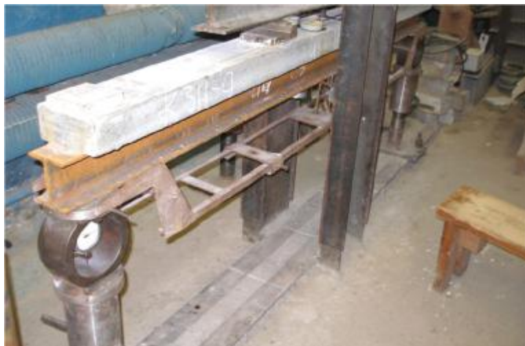
Рис. 2.8. Балка КЗН- 9 при навантаженні "позитивним" моментом
