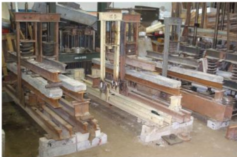
Рис. 2.9. Загальний вигляд балок, що піддалися тривалим випробуванням
