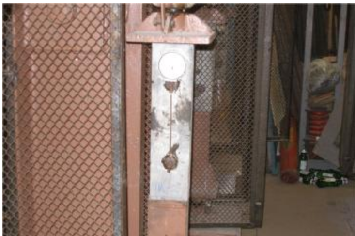
Рис. 2.10. Загальний вигляд призми в установці для тривалих випробувань
