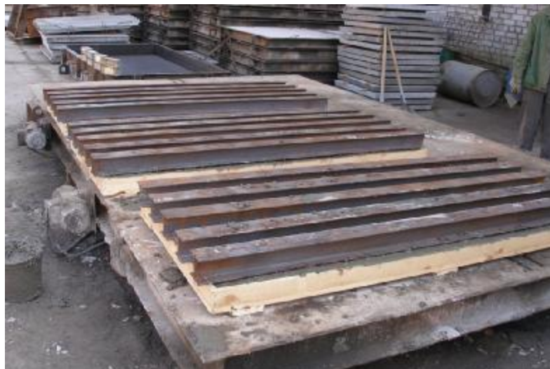
Рис. 2.3. Виготовлення балок із сталезалізобетону
