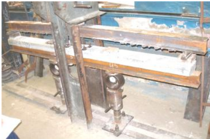
Рис. 2.7. Балка КЗН- 9 при навантаженні "негативним" моментом
