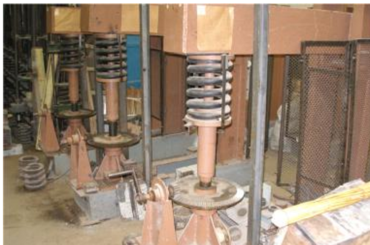
Рис. 2.11. Загальний вигляд установки для тривалих випробувань призм
