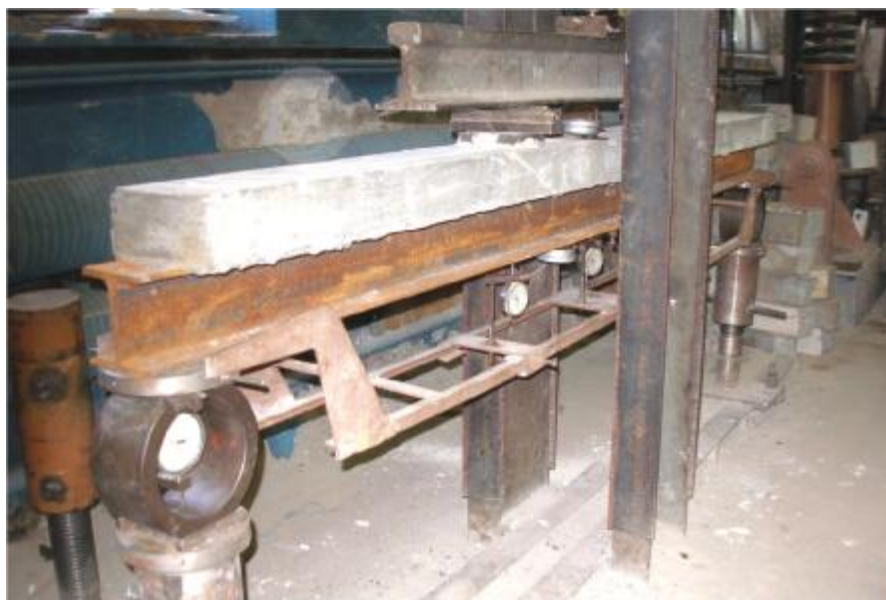
Рис. 2.4. Вдосконалені опорні пристосування, використовувані при випробуваннях балок із сталезалізобетону
