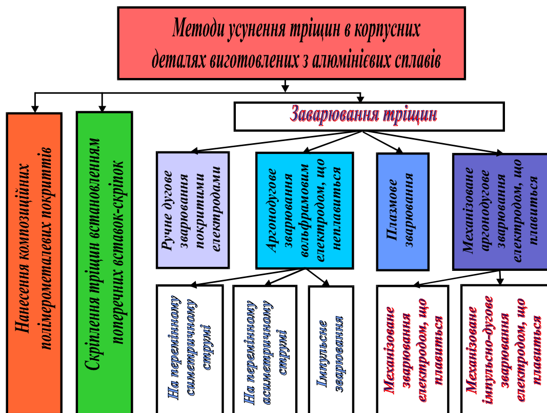
Рисунок 2.1. - Класифікація методів й способів видалення тріщин на поверхнях в деталей виготовлених із сплавів на основі Al
