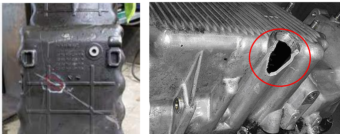
Рисунок 1.8. – Тріщини та руйнування піддонів блок-картерів ДВЗ
