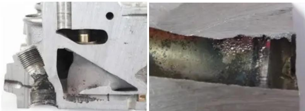
Рисунок 1.9. – Скриті дефекти ГБЦ ДВЗ
