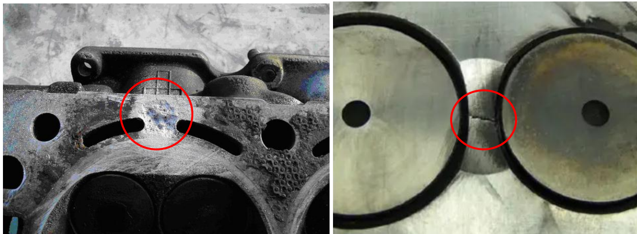
Рисунок 1.6. – Найбільш часті дефекти ГБЦ:
