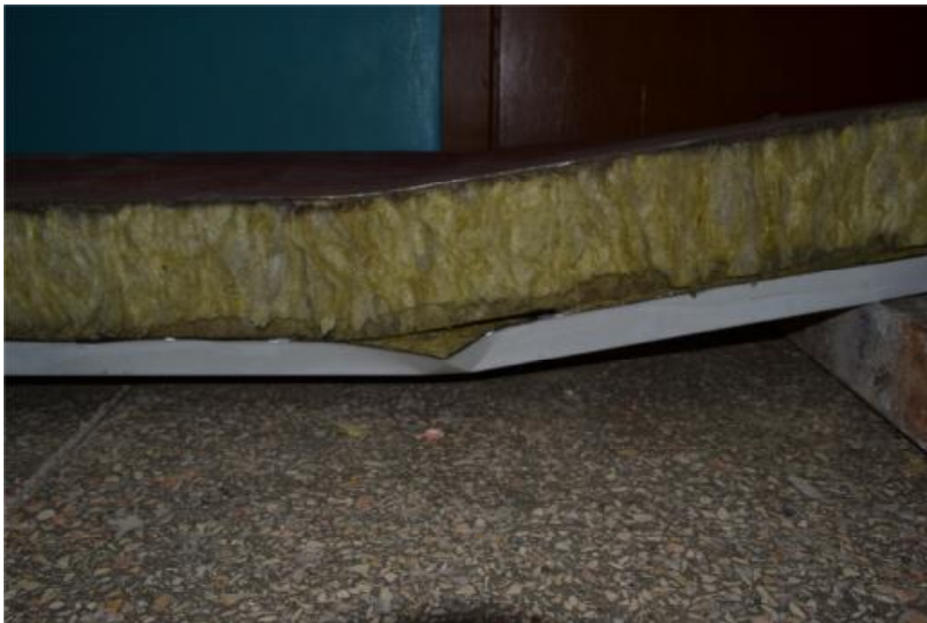
Рисунок 4.13 Злам випробуваного зразку СП
