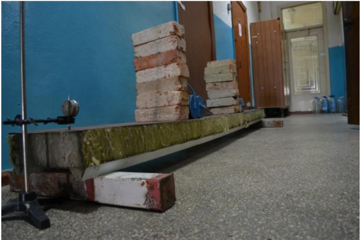
Рисунок 4.12 Прогин випробуваного зразка СП
