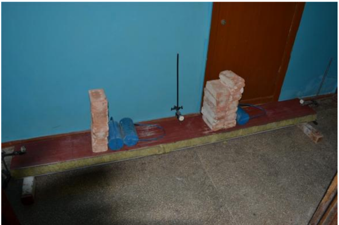
Рисунок 4.11 Загальний вигляд випробуваного зразка при третьому ступені навантаження
