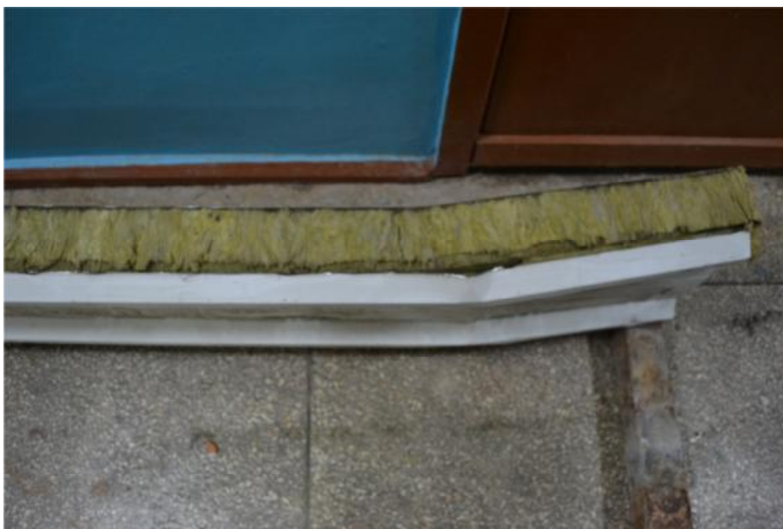
Рисунок 4.14 Злам випробуваного зразку СП
