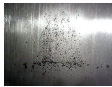
Зношене покриття циліндра двигуна БМВ
