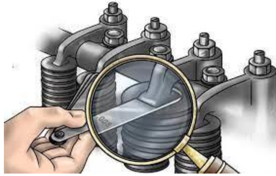
Рисунок 2.1 Перевірка теплового зазору за допомогою щупа.
