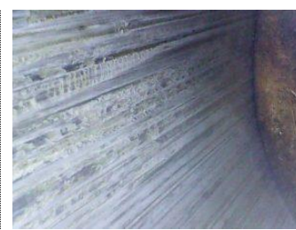
Задирання в циліндрі двигуна Мерседес ML
