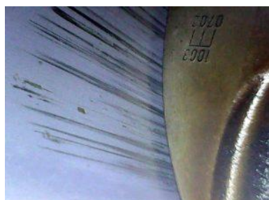
Здертий шар покриття циліндра двигуна Мерседес
