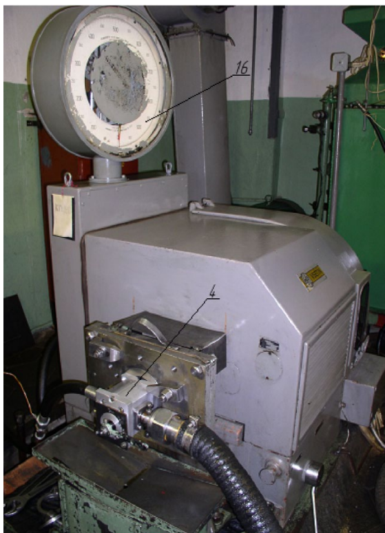
Рисунок 8.1 Загальний вид установки для експериментального дослідження основних технічних характеристик шестеренного насоса.
