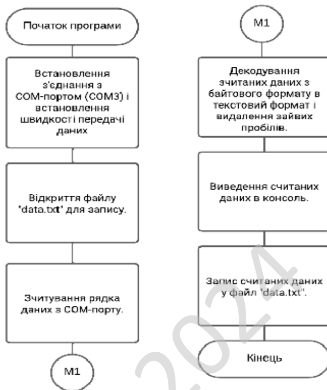
Рисунок 4.3 – Блок-схема програми для записування даних у файл
