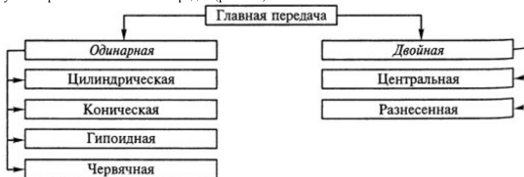
Рисунок 5.8 – Типи головних передач
