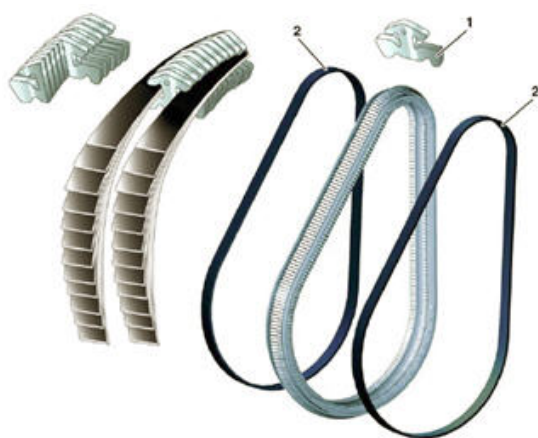
1 - елемент; 2 пакет дисків (по 12 кілець) Рисунок 4.24 - Пас і ланцюг варіатора
