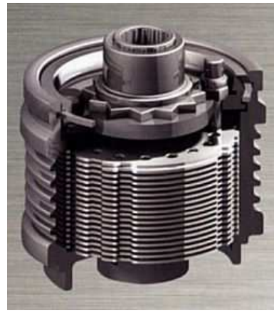
Рисунок 5.16 – Дисковий міжколісний диференціал із частковим блокуванням
