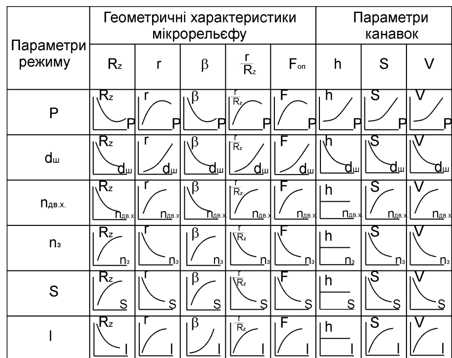
Рис.2.11. Типові залежності геометричних параметрів якості поверхні від параметрів режиму вібронакочування.
