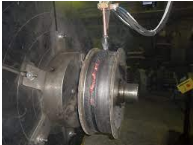
Рис.2.3. Загальний вигляд процесу наплавлення під шаром флюсу
