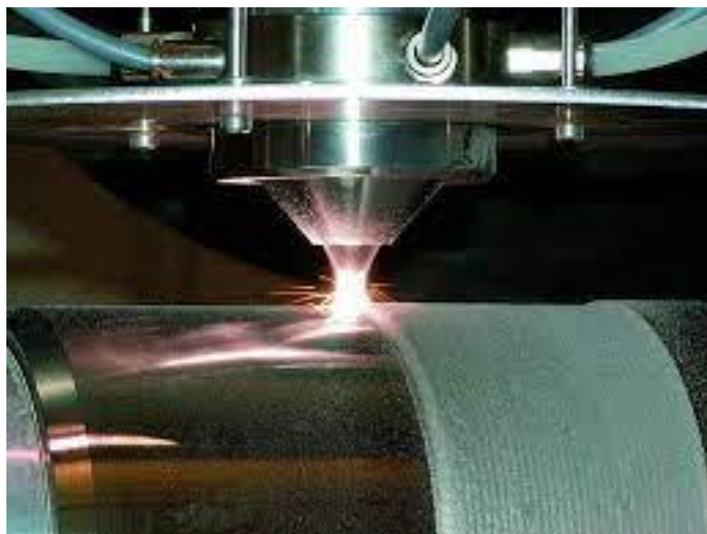
Рис.2.5. Сутність плазмового напilenня [17]
